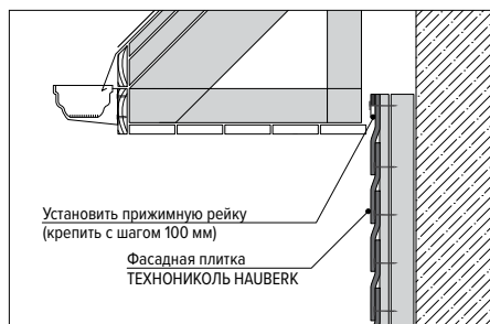
Рис. 9.1. Монтаж верхнего ряда под карнизным свесом. Вариант 1
