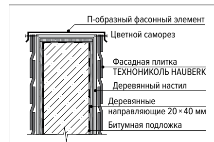
Рис. 11.2. Монтаж фасадной плитки на подпорную стенку. Вариант 2
